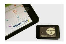
Control+ ist eine sehr kleine Infrarot- und Funk-Sendeeinheit, die Ihr REHAVISTA-Pad in eine Umfeldsteuerung verwandelt.
